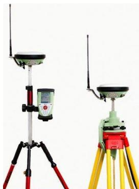
Рис. 7 – Комплект база и ровер Leica GS14
